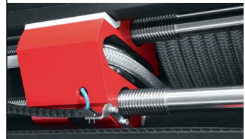
Sorgen auch bei loser Schot für eine saubere Lage auf der Trommel.
