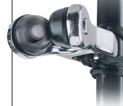
Vorfädler: Hardcoat-eloxierte, PTFE-beschichtet Alu Rollen drehen frei auf reibungsarmen Buchsen.
