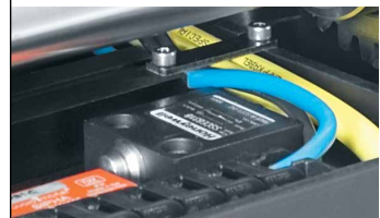
Redundante Näherungs-Schalter verhindern Über-Lauf.
