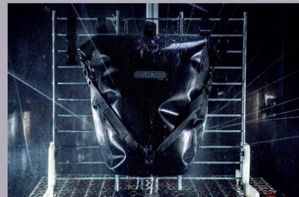
Die ORTLIEB Produkte stehen für höchste Qualität, entsprechend intensiv sind die Testprozesse. Natürlich wird auch die Wasserdichtigkeit überprüft.
